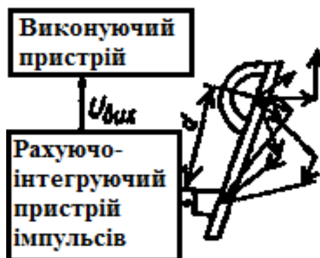
Рис. 6. Радіоізотопний метод середніх і великих висот [1]
